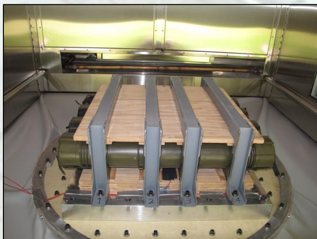
Système de vibration avec table de vibration, 23 600 livres-force, accélération maximale de 150 g, 5 Hz à 2000 Hz et chambre climatique AGREE.
