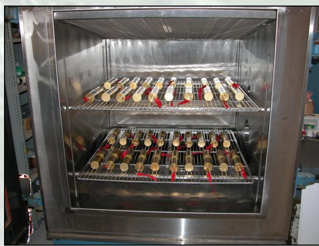
Chambre climatique de température/humidité/altitude, 64 pi³, -55 °C à 177 °C, 15 à 95 % d'humidité relative, 0 à 80 000 pieds d'altitude.
